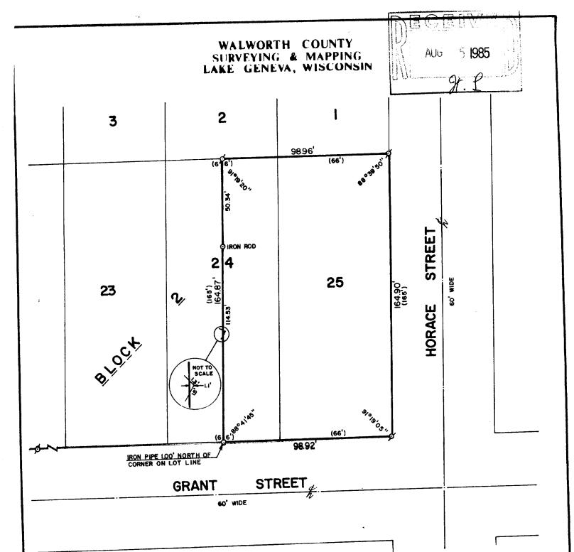
NOTE: INSERT SHOWS ENCROACHMENT OF RAILROAD TIE RETAINING WALL
